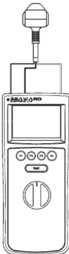
Rys. 6 Pomiar napięcia sieci/RCD/impedancji pętli, linii
