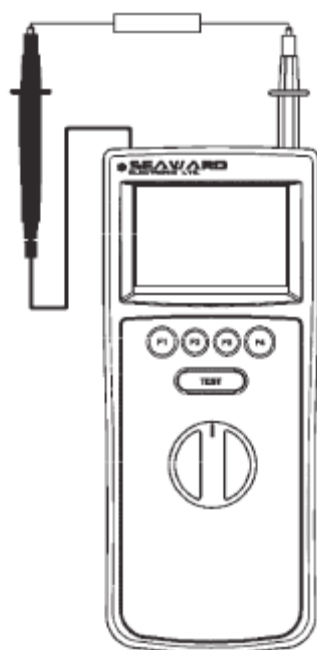
Rys. 4 Pomiar ciągłości uziemienia/ rezystancji izolacji z użyciem bezprzewodowej sondy
